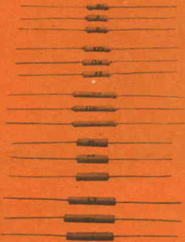
Ecco alcuni dei nuovi resistori a strato con conduttori assiali.
