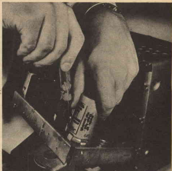
Togliere un vibratore può essere difficile. Se è necessario, piegate indietro le graffette intorno allo zoccolo mentre fate andare avanti e indietro il vibratore sollevandolo.
