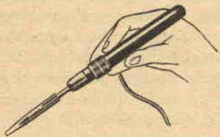
Saldatore miniaturizzato per circuiti stampati
